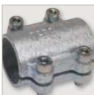
Klasické třmeny k utěsnění otvorů, trhlin a poréznicích míst ve vodovodním ocelovém potrubí o průměru 17,2–114,3 mm. Strana 12
