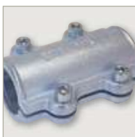
Dlouhé třmeny k utěsnění otvorů, trhlin a poréznicích míst ve vodovodním ocelovém potrubí o průměru 17,2–114,3 mm. Strana 14
